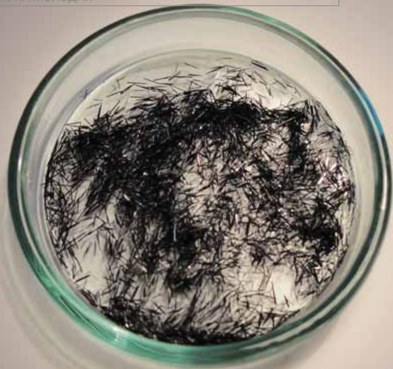
Кристаллы комплекса \text{Cu}(\text{hfac})_2\text{L}^{\text{Me}} , демонстрирующие рекордные изменения объёма и линейных размеров (~12%) в ходе обратимого фазового превращения
