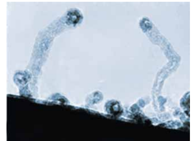
Растущие на несущем слое углеродные нанотрубки можно получать с помощью учебно-исследовательской установки CVDompa. ПЭМ-изображение
